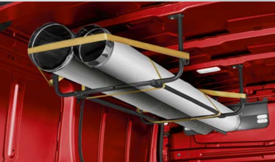
Halterungen im Dachhimmel innen (52)
